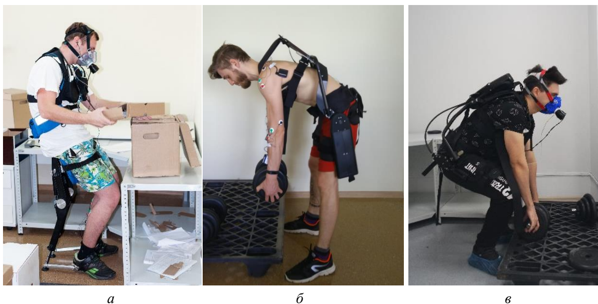
Рис. 1. Образцы прототипов промышленного экзоскелета: а – ППЭ-1; б – ППЭ-2; в – ППЭ-3
