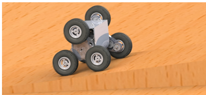
Рис. 8. Испытание СТС на наклонной поверхности
