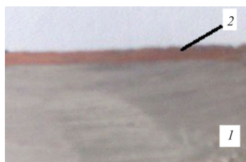
Рис. 3. Алюминиевый ЭИ с нанесенным медным покрытием: 1 – алюминиевое основание; 2 – медное покрытие
