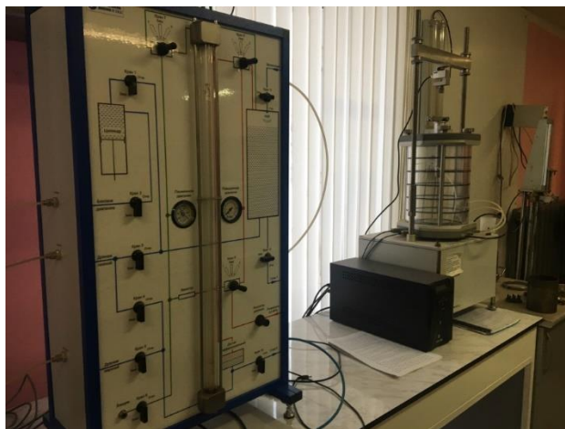
Рис. 2. Установка трехосного сжатия с установленной рабочей камерой
