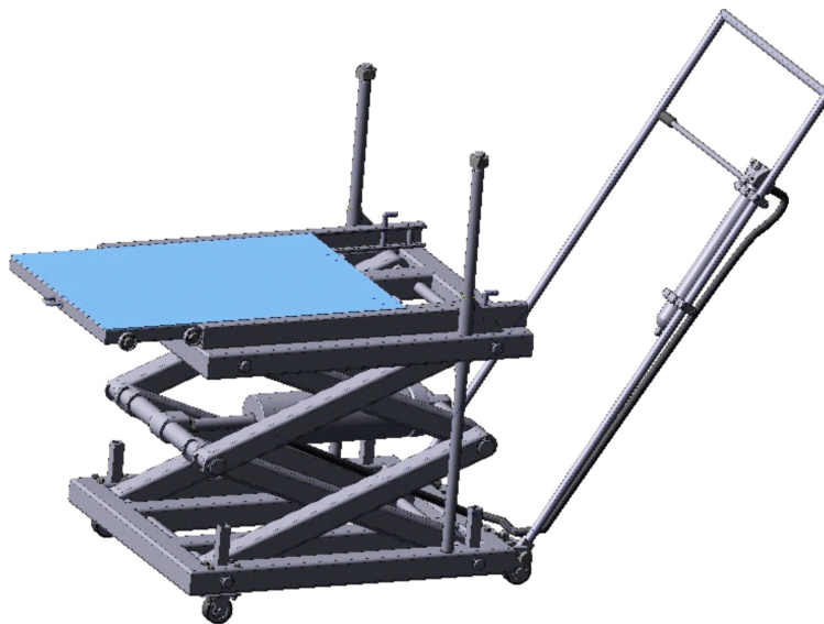
Рис. 5. Грузоподъемное оборудование, разработанное в среде моделирования КОМПАС 3D
