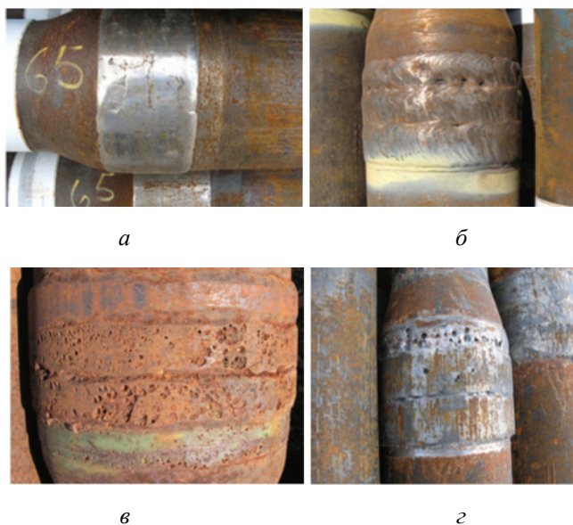
Рис. 1. Дефекты, возникающие при наплавке замков бурильных труб [1]: а – трещины; б – свищи; в, г – пористость
