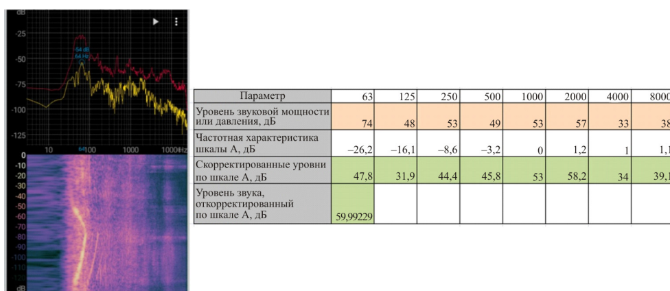
Рис. 1. Спектрограмма из приложения Spectroid и таблица корректировки уровня шума по шкале А
