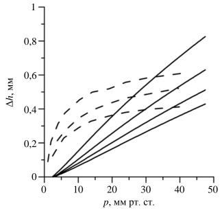
Рис. 3. Сравнение расчетных кривых для линейной модели с данными экспериментов. Пунктиром показаны экспериментальные кривые: сверху вниз образцы 2, 5 и 12 по [6]. Сплошные линии сверху вниз:  $E_c = 0.3$ ; 0,4; 0,5; 0,6 МПа
