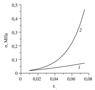
Рис. 1. Зависимость напряжения  $\sigma$  от деформации  $\varepsilon$  при изотропном растяжении:  $I-\varsigma=10;\ 2-\varsigma=50;\ E_c=0,3\ \mathrm{M}\Pi \mathrm{a}$
