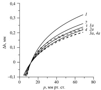
Рис. 6. Зависимость смещения апекса роговицы от давления. Сплошные кривые 1—4 соответствуют жесткостям  $E_c=0,4;\ 0,5;\ 0,6;\ 0,7$  МПа и коэффициентам нелинейности  $\varsigma=50$  (кривая 1) и 60 (кривые 2—4); на пунктирных кривых 1a—4a при тех же значениях жесткости коэффициент нелинейности  $\varsigma=90$  (кривая 1a), 80 (кривые 2a, 3a) и 70 (кривая 4a)
