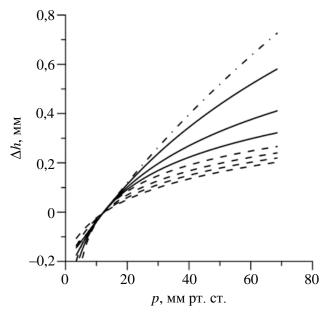
Рис. 4. Влияние жесткости и параметра нелинейности на зависимость смещения апекса роговицы от давления: сплошные линии (сверху вниз) —  $E_c=0.4$  МПа,  $\varsigma=10,\ 30,\ 50;$  пунктирные линии (сверху вниз) —  $\varsigma=70,\ E_c=0.4;\ 0.5;\ 0.6;$  0,7 МПа; штрихпунктир —  $E_c=0.4$  МПа,  $\varsigma=1$
