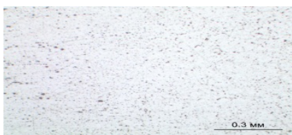
Рис. 4. Макроструктура сварного шва первого образца, \times 100 : a – не обработанного реактивом Келлера; б – обработанного реактивом Келлера
