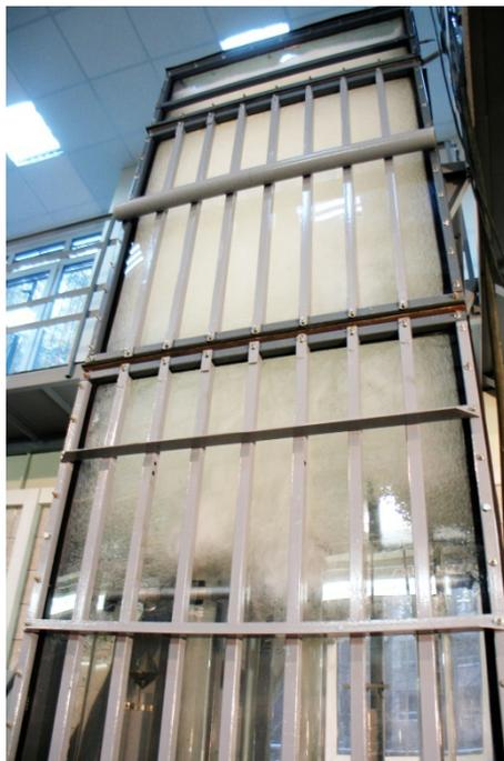
Рис. Укрупненная плоская модель окислительной колонны, работающая в комбинированном газлифтно-барботажном режиме
