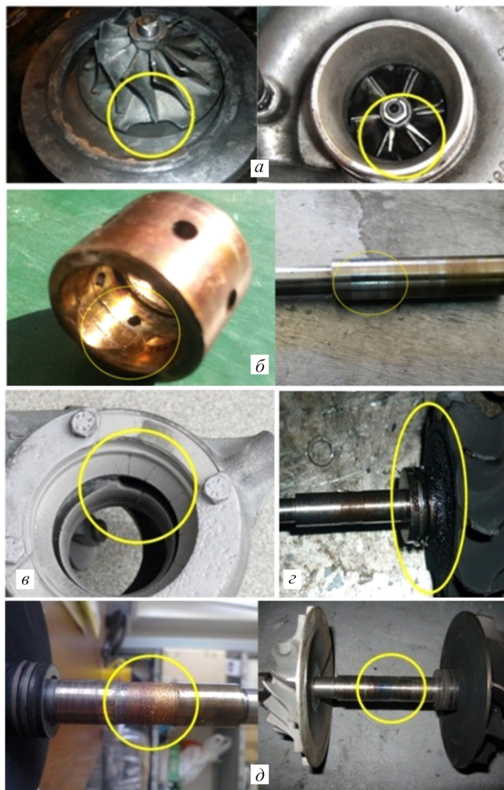
Рис. 1. Причины отказов турбокомпрессоров ТКР 80.05.12: а – попадание механических частиц; б – износ абразивными частицами; в – трещины корпуса; г – наслоение закоксовавшегося масла; д – влияние масляного голодания
