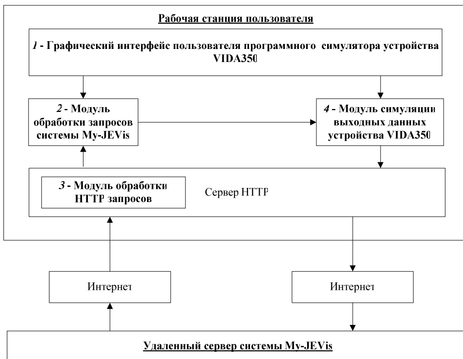
Рис. 2. Структура программного симулятора ПЛК VIDA350 в составе системы Му-JEVis
