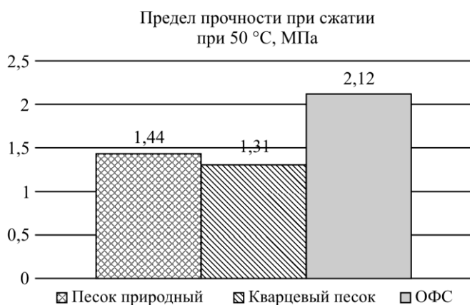
Рис. 5. Предел прочности при сжатии при 50 °С, горячего плотного мелкозернистого асфальтобетона типа Б марки I, с разным мелким минеральным наполнителем
