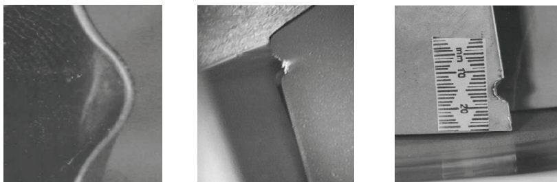
Рис. 1. Виды повреждений лопаток ГТД: вмятина, разрыв, забоина
