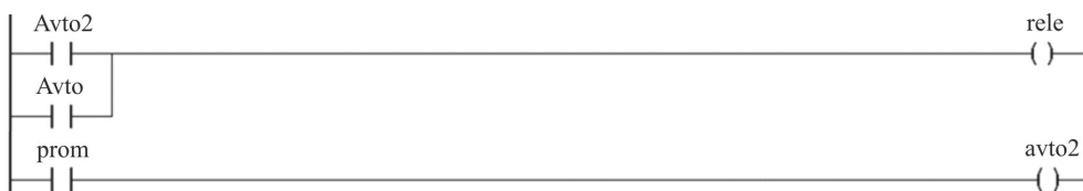
Рис. 7. Фрагмент программы на языке LD переключения режимов «местный/дистанционный». Переменные программы: «prom» – дискретный сигнал переключателя режимов «местный/дистанционный»; «Avto2» – дискретный сигнал включенного режима «местный/дистанционный»; «Avto» – дискретный сигнал для отображения на мнемосхемах; «rele» – включает дистанционный режим
