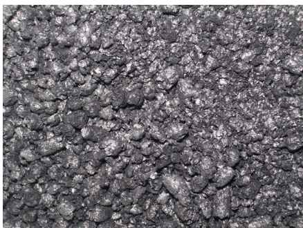
Рис. 1. Гранулирование частиц графита (ТРГ). Увлажнение порошка графита и встряхивание смеси после гранулирования в шнеке, \times 10
