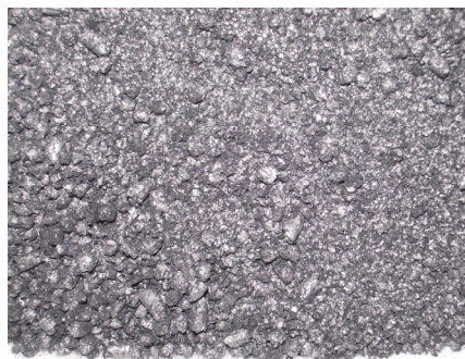
Рис. 2. Гранулирование смеси порошка из графитовых (ТРГ) частиц размером 0–400 мкм после увлажнения спирто-ацетоновой смесью, \times 10
