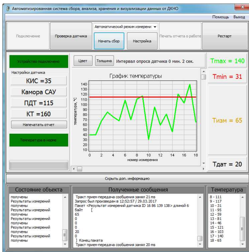
Рис. 5. Автоматизированная система контроля температуры объекта
