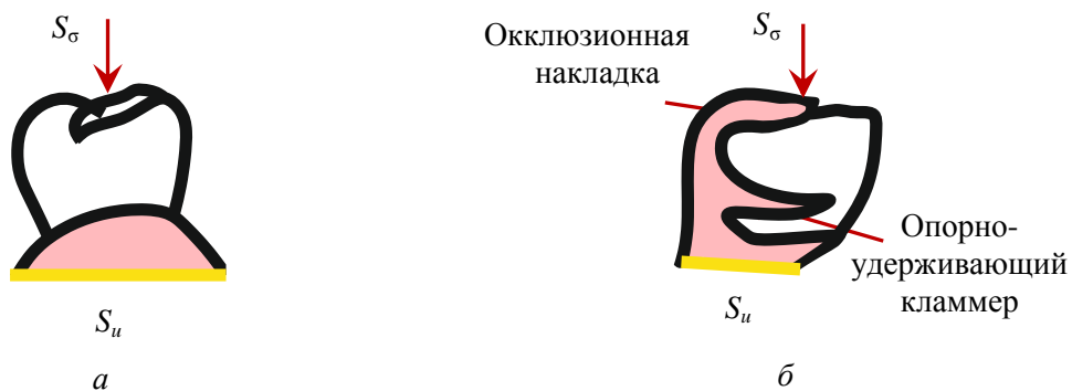
Рис. 3. Схема граничных условий: a – без окклюзионной накладке; б – с применением окклюзионной накладке
