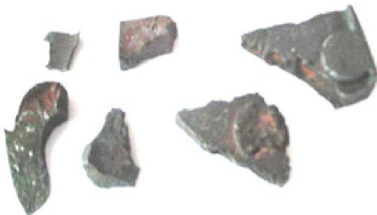
Рис. 1. Элементы тормозных колодок, выкрошившихся в результате трещинообразования
