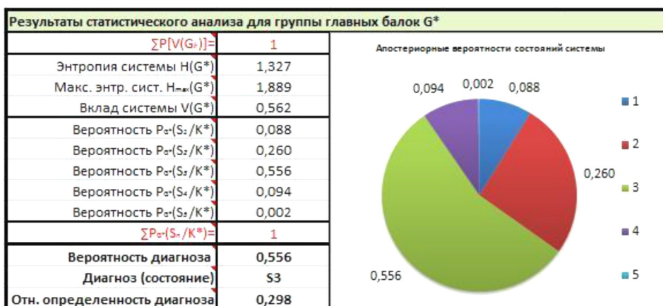
Рис. 1. Пример визуализации анализа технического состояния железобетонных балок с помощью экспертной системы, использующей вероятностные методы оценки в работе [4]
