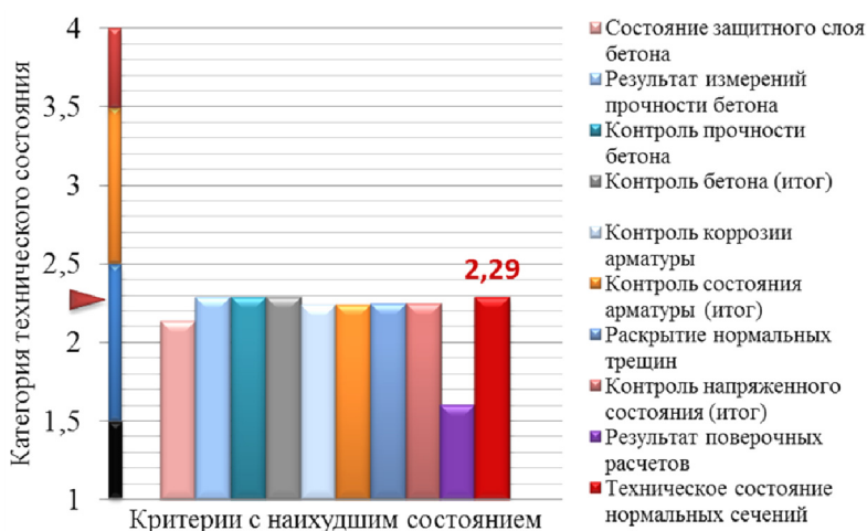
Рис. 2. Пример визуализации промежуточных значений оценки технического состояния железобетонной балки с использованием теории нечетких множеств в работе [16]
