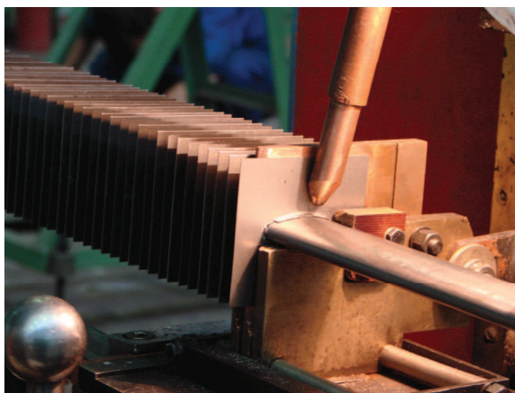
Рис. 2. Труба овальной формы с ребрами перед сваркой
