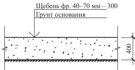
Рис. 1. Схема устройства временной дороги по 1-му варианту
