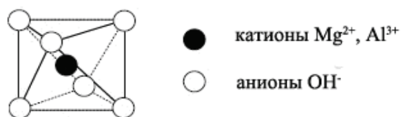
Рис. 2. Схематичное изображение структуры полученного двойного гидроксида магния-алюминия
