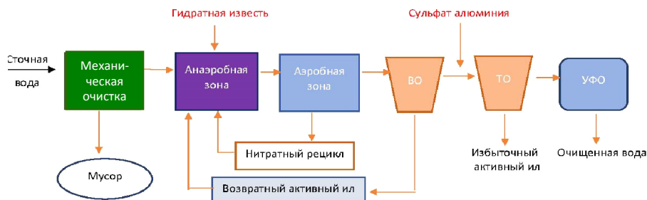
Рис. 5. Технологическая схема установки очистки бытовых стоков:
