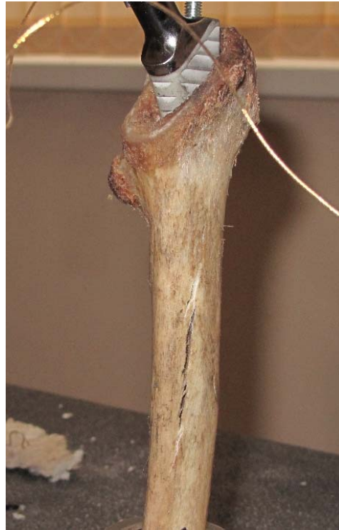
Рис. 8. Разрушение кости на третьем этапе эксперимента
