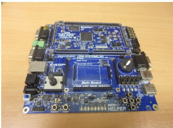
Рис. 4. Ранний вариант платы LDM-Helper с установленной процессорной платой с микроконтроллером K1986BE1QI
