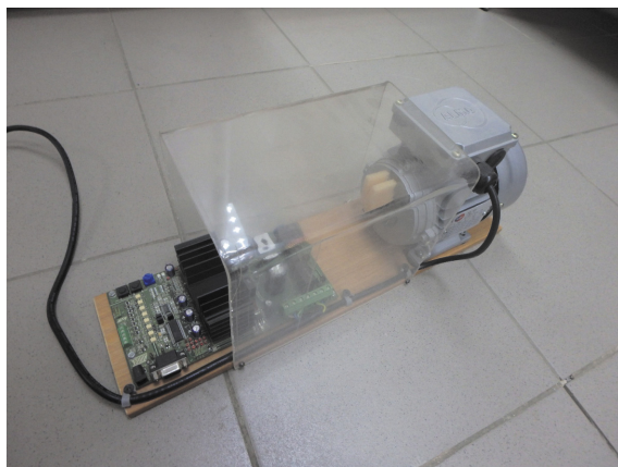
Рис. 1. Лабораторный стенд управления электродвигателем на основе отладочной платы от Atmel
