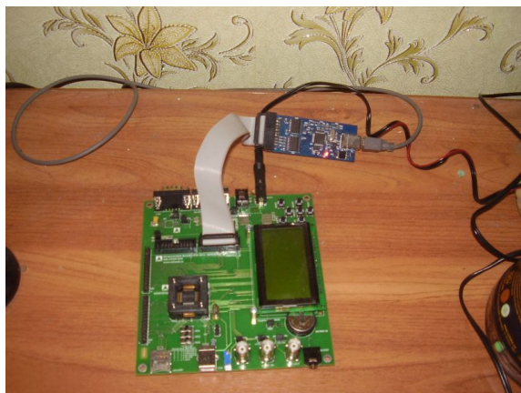
Рис. 3. Отладочная плата производства ПМК «Миландр» для микроконтроллера MDR32F9Q2I
