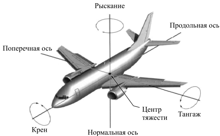
Рис. 1. Основные оси вращения самолета в пространстве
