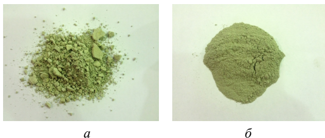
Рис. 1. Внешний вид алюмосодержащего отхода: а – в исходном состоянии; б – в измельченном состоянии
