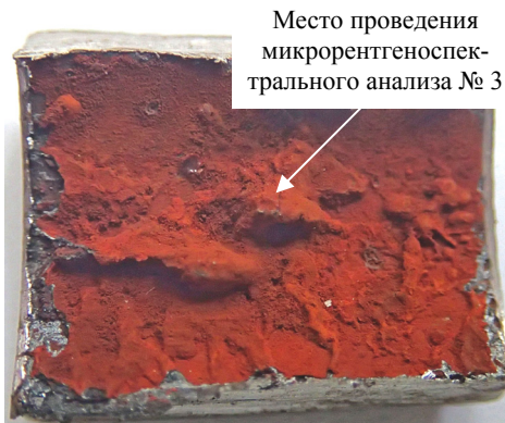
Рис. 4. Внутренняя поверхность фрагмента трубы № 2
