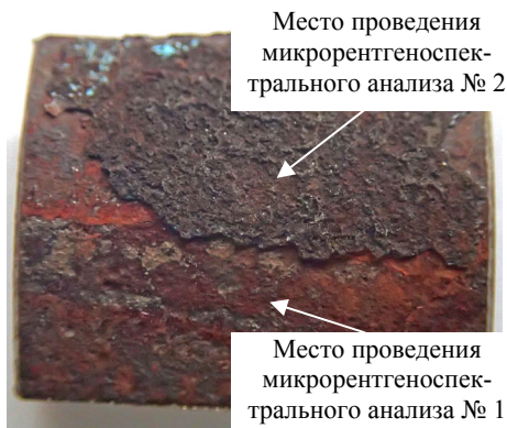
Рис. 3. Наружная поверхность фрагмента трубы № 2
