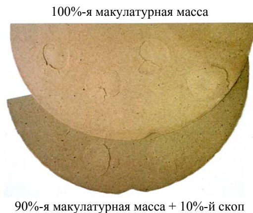
Рис. Лабораторные отливки бумажного полотна
