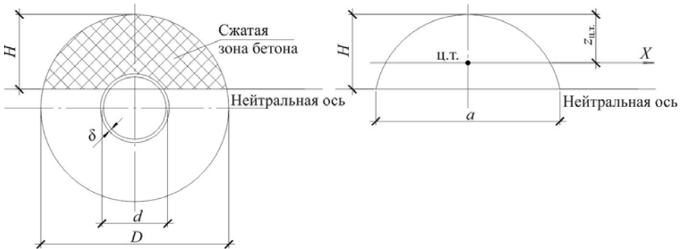
Рис. 2. Положение нейтральной оси грунтоцементного элемента
