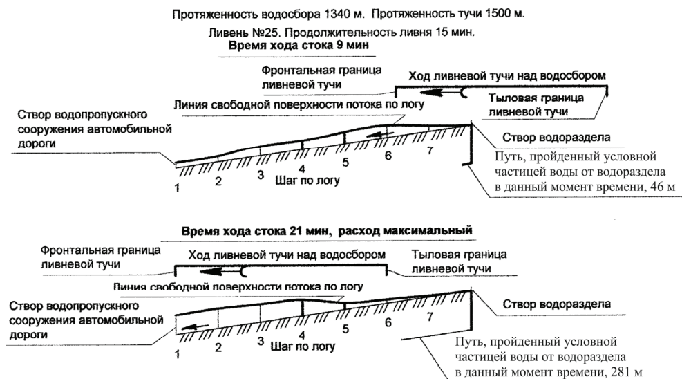
Рис. 4. Формирование паводковой волны на момент максимального расхода стока с водосбора до застройки
