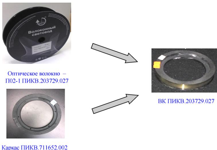
Рис. 1. Состав волоконной катушки
