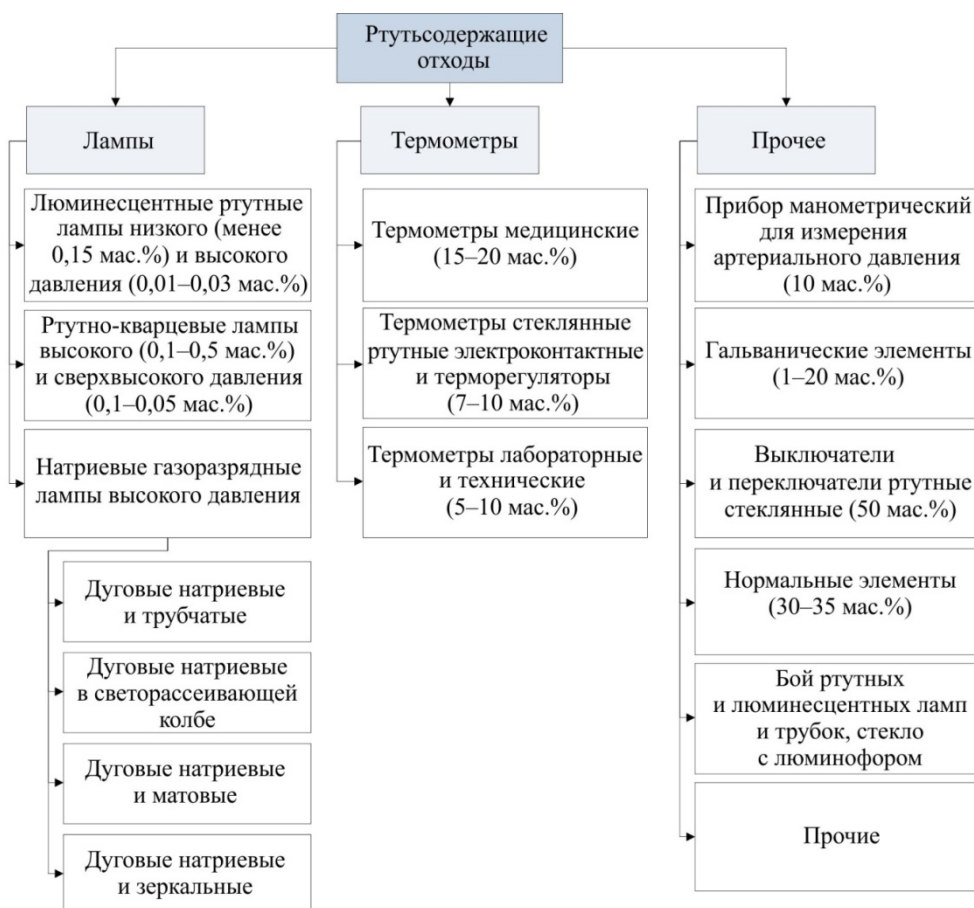
Рис. 2. Классификация ртутьсодержащих отходов
