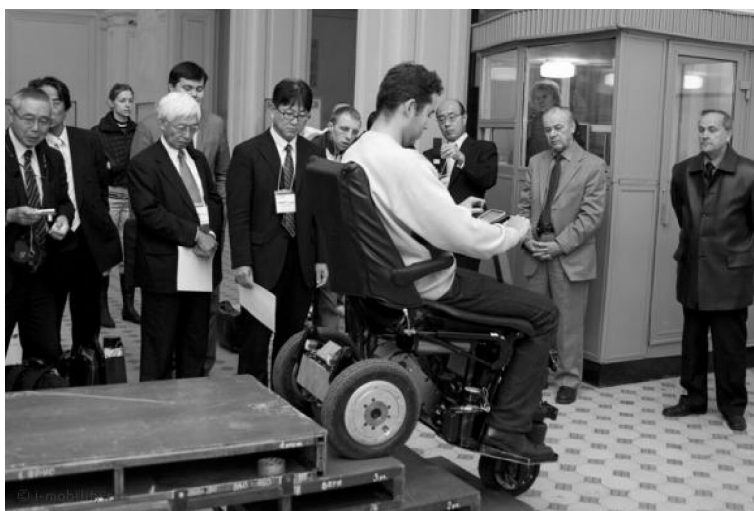
Рис. 5. Демонстрация делегации из Японии ходового макета транскутера семейства Kangaroo в режиме «лестница вниз»
