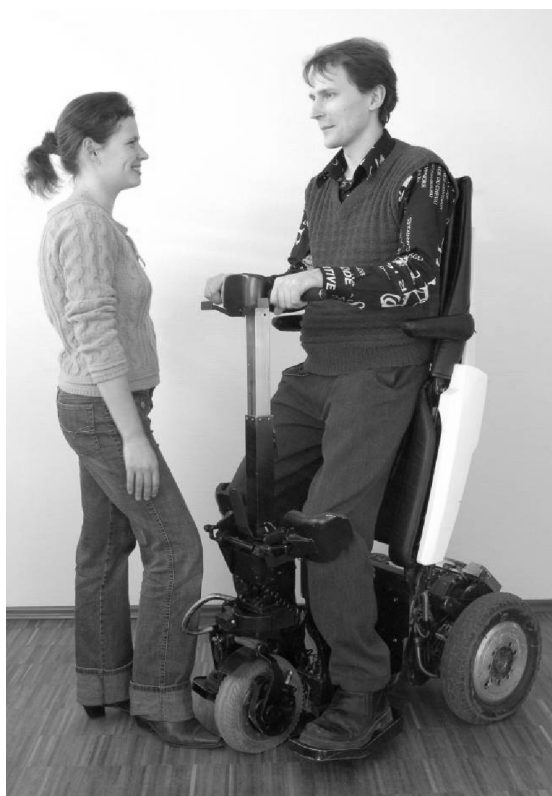
Рис. 4. Ходовый макет транскутера семейства Kangaroo в режиме «вертикаль»
