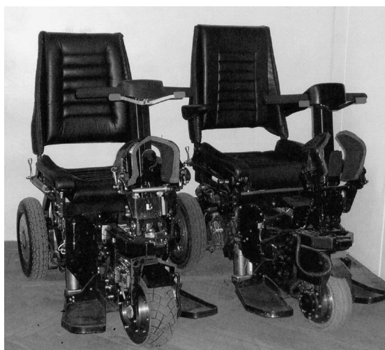
Рис. 3. Два экспериментальных образца Kangaroo в Лаборатории электродвижения «на ступелях»
