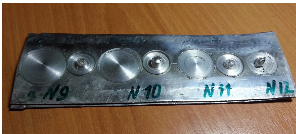
Рис. 6. Точечные соединения, полученные на разных режимах: № 9 – n = 1600 об/мин, диаметр плоского инструмента 30 мм; № 10 – n = 1250 об/мин, диаметр плоского инструмента 30 мм; № 11 – n = 1000 об/мин, диаметр плоского инструмента 24 мм; № 12 – n = 800 об/мин
