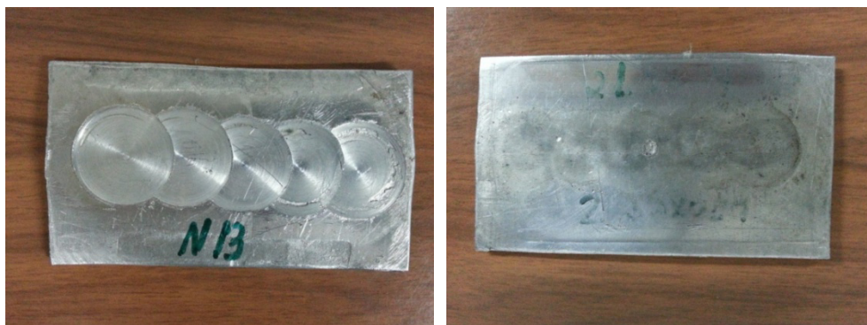
a б Рис. 5. Нахлесточное соединение с перекроем точек: a – лицевая сторона шва; б – обратная сторона шва
