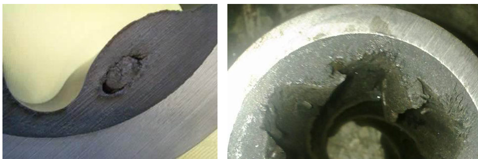
Рис. 3. Разрушение зубьев статора вследствие циклических деформаций
