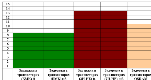
Рис. 24. Сравнение быстродействия по количеству транзисторов в наиболее «длинном» пути сигнала со входа на выход троированных вариантов SRAM и QSRAM
