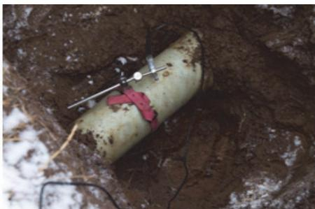
Рис. 5. Пример крепления датчика на трубопроводе ТСК
