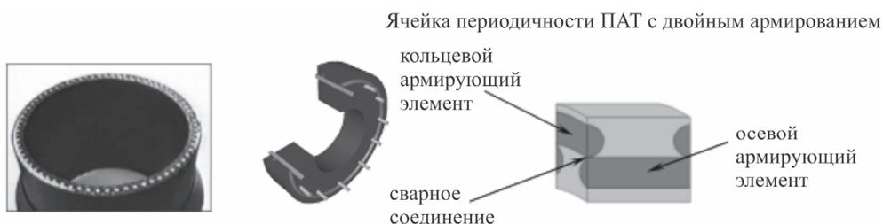
Рис. 1. Полимерно-армированная труба в разрезе (схема ячейки)
