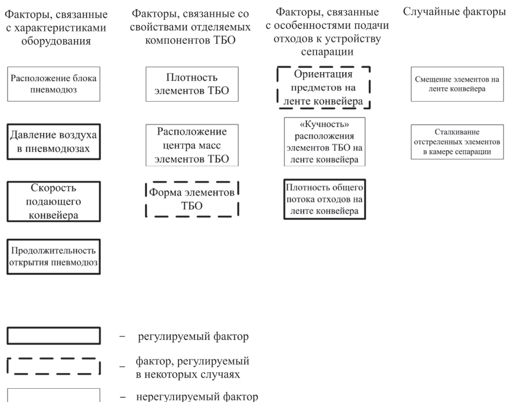
Рис. 3. Обзорная схема факторов, влияющих на эффективность воздушной сепарации. Величина шрифта пропорциональна значимости фактора
