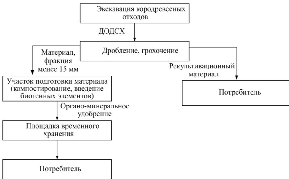
Рис. 4. Технологическая схема использования кородревесных отходов
