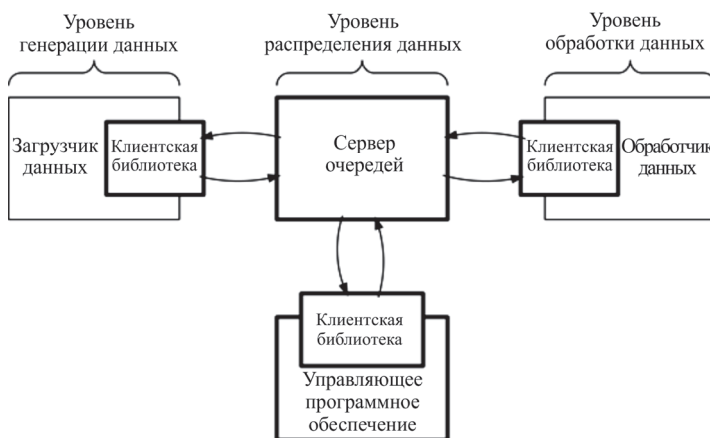
Рис. 3. Логическая структура взаимодействия компонент комплекса программного обеспечения
