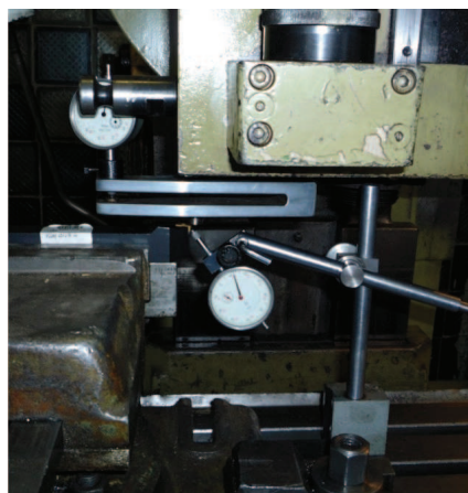
Рис. 5. Общий вид измерения жесткости различных схем крепления режущих пластин на токарных резцах
