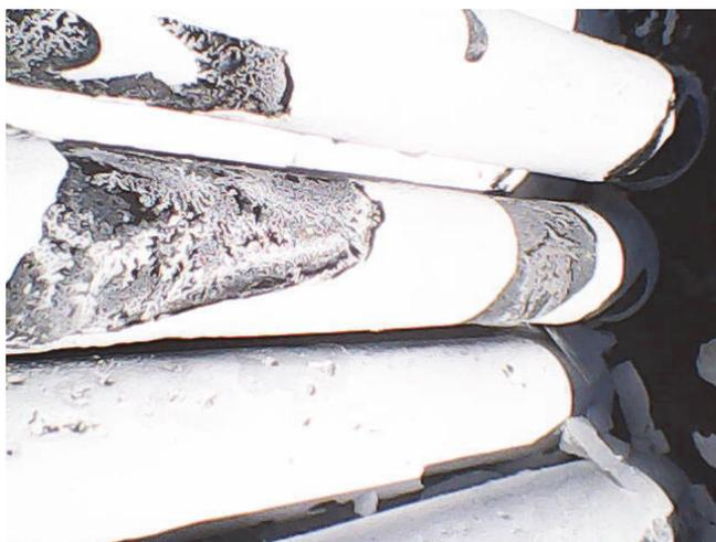
Рис. 1. Пучок внутренних труб парогенератора, покрытых продуктами разложения бинарного теплоносителя
