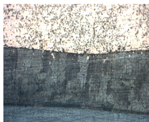
Рис. 2. Микроструктура наплавленного слоя на токе прямой полярности. \times 200
