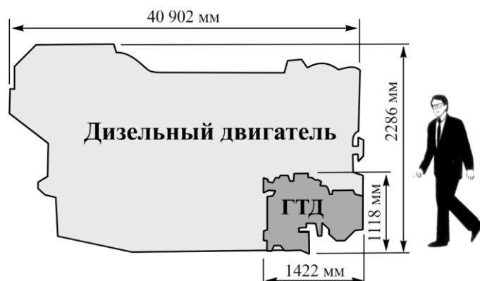
Рис. 1. Сравнение габаритных размеров ГТД и дизельного двигателя мощностью 3 МВт
