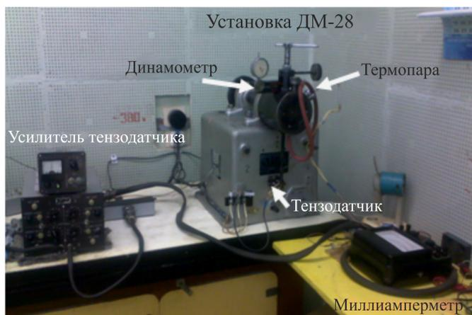
Рис. 2. Стенд экспериментальной установки
