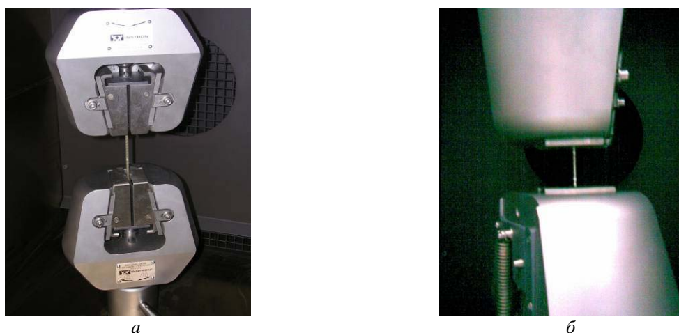
Рис. 6. Образцы в захватах: а – стержень, б – образец стандартной формы
