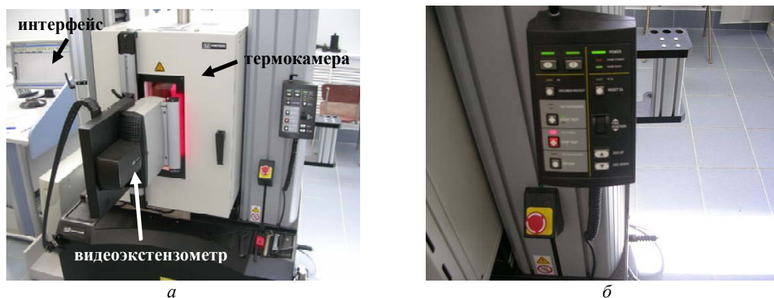
Рис. 5. Машина для испытаний Instron-5882: а – общий вид устройства, б – панель управления
