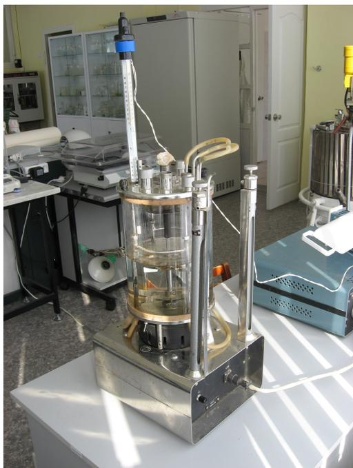
Рис. 4. Автоматизированная система «Фермакс - 3» (ферментер)
