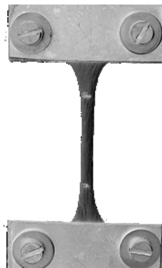
Рис. 2. Растянутый образец в захватах
